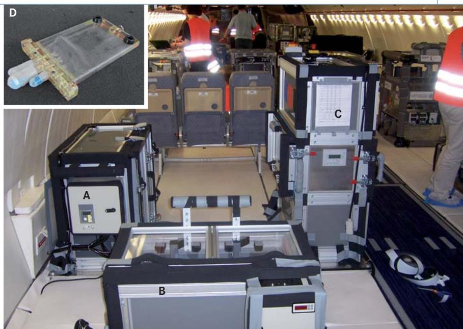
▲ **Abb. 2:** Experimentapparat aus drei Modulen in In-Flight-Konfiguration: A, Inkubator, B, Kühlmodul, C, Arbeitsmodul und D, doppelwandiges Zellgefäß.
