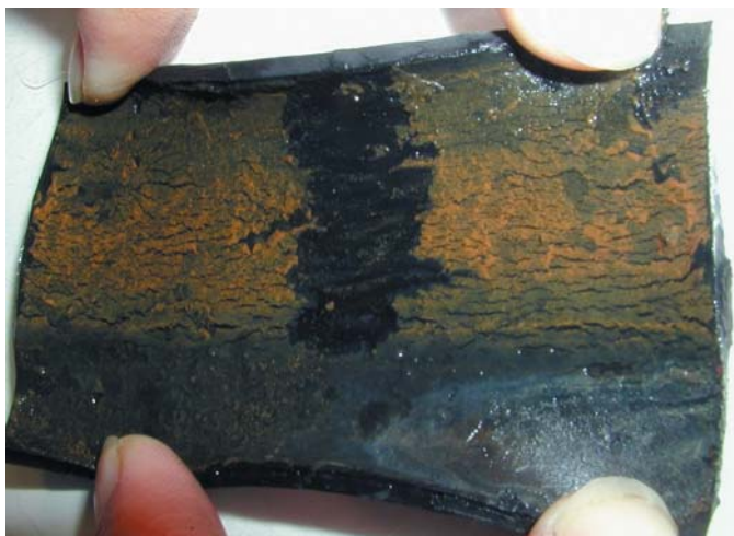
Abb. 2: Biofilm auf der Innenseite eines handelsüblichen Duschschlauchs nach 14-tägigem Durchströmen mit Trinkwasser. Durch die oft großen Mengen an bioverfügbaren Substanzen in den Schläuchen entwickeln sich dicke Biofilme, in denen große Mengen an Amöben, potenzielle Wirte für Legionellen, vorkommen.
