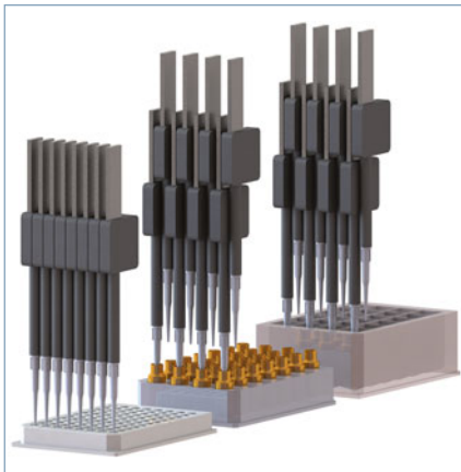
▲ Abb. 1: Dosierung mit klassischem Liquidhandler mit Achtfach-Kanal-Pipetten. Links: Dosierung in Mikrotiterplatte, Mitte: Dosierung in Zwei-Milliliter-GC-Vials, rechts: Dosierung in Falcon-Zentrifugengefäße.
