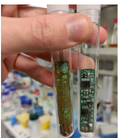
◀ Abb. 1: Leiterplatte nach 20 Tagen in der bakteriellen Biodismantling-Lösung, bereit für den weiteren Prozess der Metallrückgewinnung (links) – im Vergleich zum Original (rechts).
